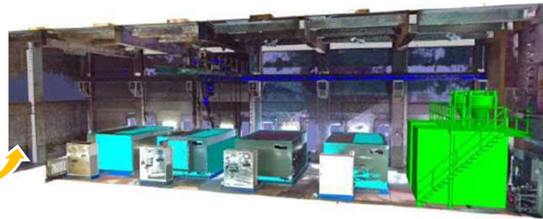
機械・電気・建築付帯 3次元・点群併用モデル 出典：「下水道事業におけるBIM/CIM活用事例」 (令和3年3月 国土交通省)
