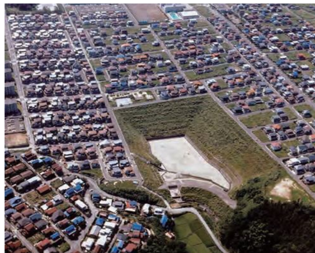
▲開発にあわせて設置された雨水調整池(栄区 桂台2号雨水調整池)
