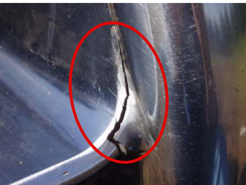
▲ 滑り降り部端部の亀裂
