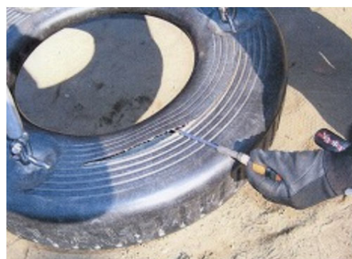
▲ 座面(タイヤ)の破損
