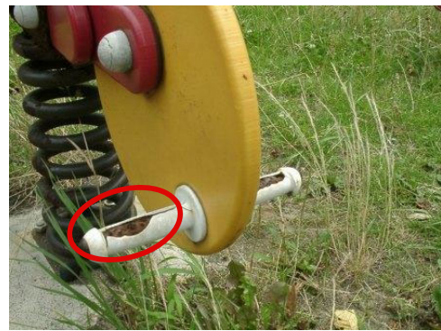
▲ 足掛部の損傷
