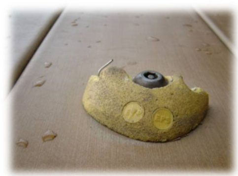
▲ クライムホールドの破損
