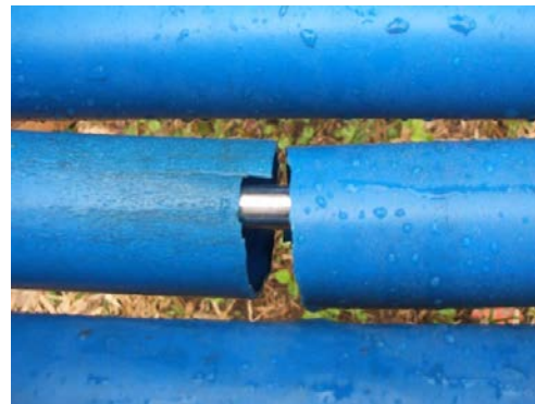
▲ ロールーすべり台のローラー破損
