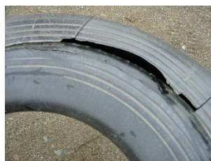
ゴム系素材の劣化状
