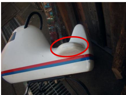
▲ 本体の亀裂（FRP製）
