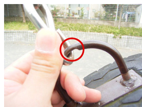
▲ タイヤ取付リングの摩耗
