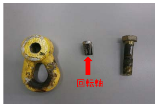
▲ 回転軸の破損
