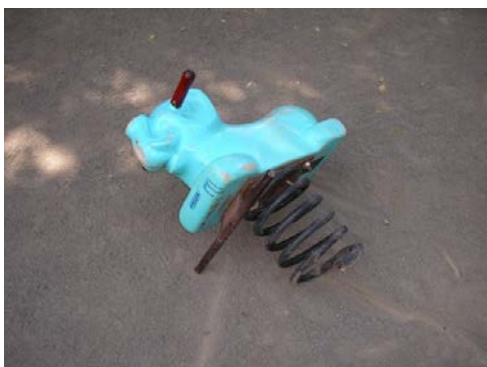
▲ スプリングの破損
