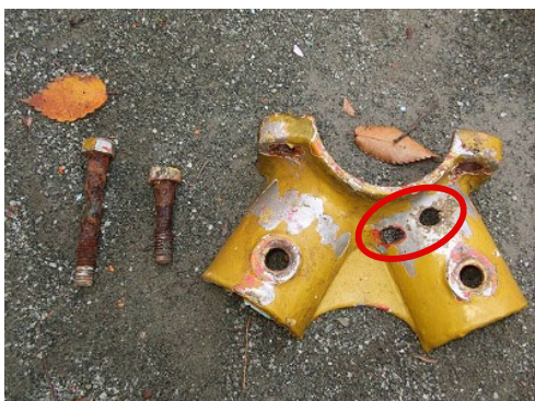
▲ ブランコ支柱継ぎ手金具（鋳物）の穴
