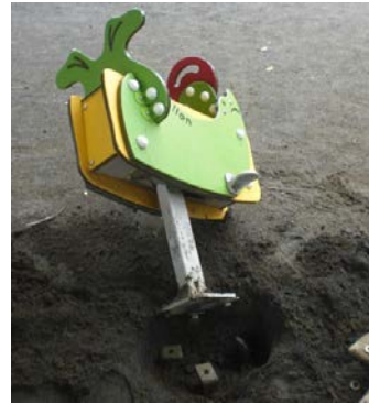
▲ ボルト欠損、アンカープレート破断
