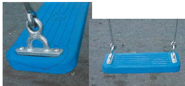
F R P 座板の変形 座板が変形し、 チェーンを固定する台座が湾曲
