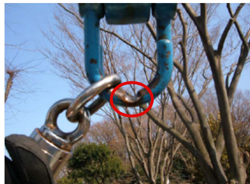
▲ 上部吊金具摩耗
