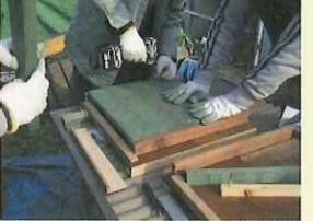
お花箱の組立開始です。二人一組で、電動工具を使いビスで止めます。約30分でひと箱仕上げました。設置する場所に合わせて作るため、約10日間掛けて46個が完成しました。
