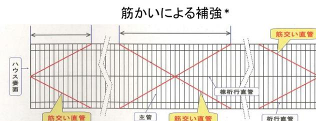
筋交いによる妻面の補強方法事例
