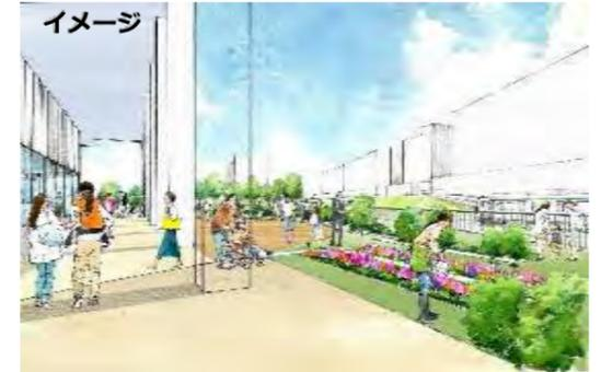
高層部(病棟)と中低層部のボリュームを分節してセットバックさせることで病院のスケールを抑え公園のスケールと調和
