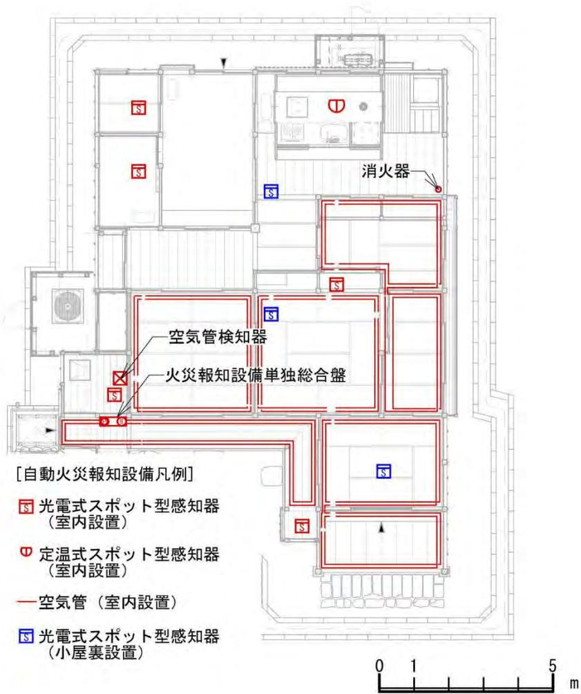
図 3-8 防災設備平面図 (建物)
