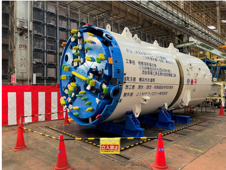
相模湖系導水路（川井接合井から西谷浄水場）改良事業 シールドマシン
