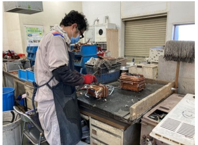
▲給湯器の中身を 手作業で解体する様子。
