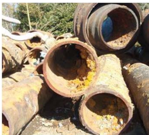
鋳鉄管(CIP) ※赤水や漏水の発生原因
