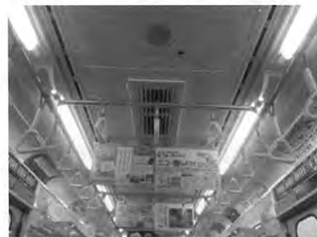
【LED 化した地下鉄車内の照明】
