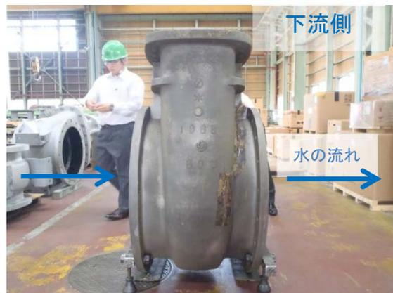
写真 4 バルブのひび割れの状況
