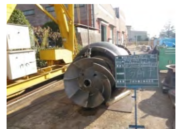
ポンプの再整備 (長寿命化)
