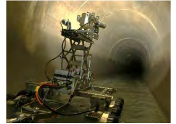
中大口径管用 TV カメラの例
