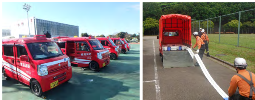
写真 (左) ミニ消防車 (右) 遠距離に送水するための資機材
