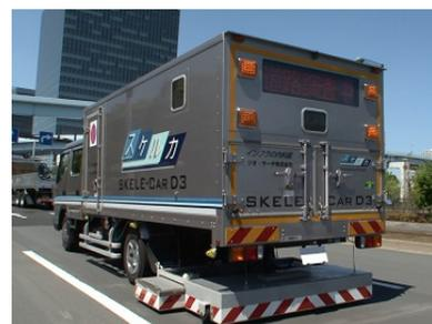
空洞探査車による調査
