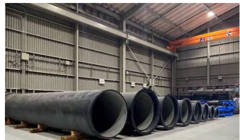
水道局で備蓄している修理材料
