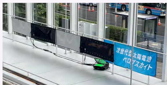
ペロブスカイト太陽電池の実証実験 (市庁舎アトリウム)
