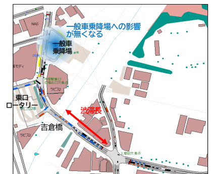
図2 交通社会実験の際の上倉田交差点から伸びる渋滞(右折専用レーンを延伸した場合)
