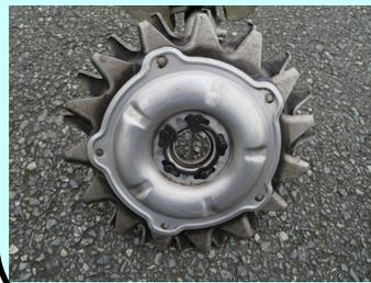
二枚刃の刃が、はさみのように、草を挟んで刈り込みます。操作がしやすく、石などの飛散事故を起こしにくい構造です。
