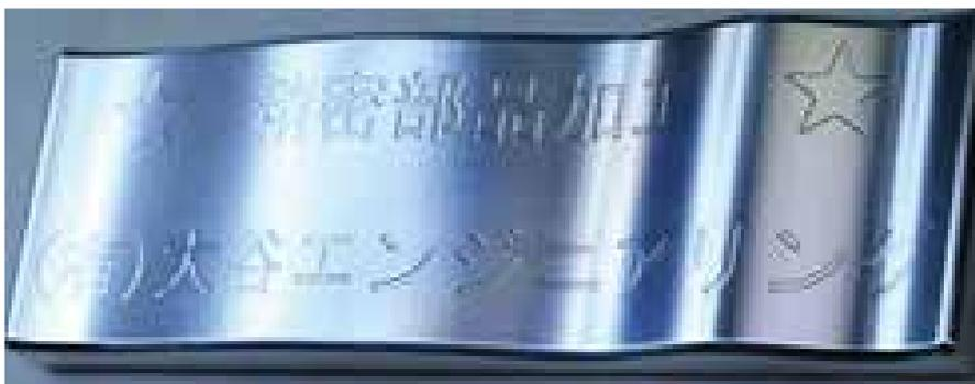
◇材質A5052 曲面に文字彫りした3次元加工サンプル品
